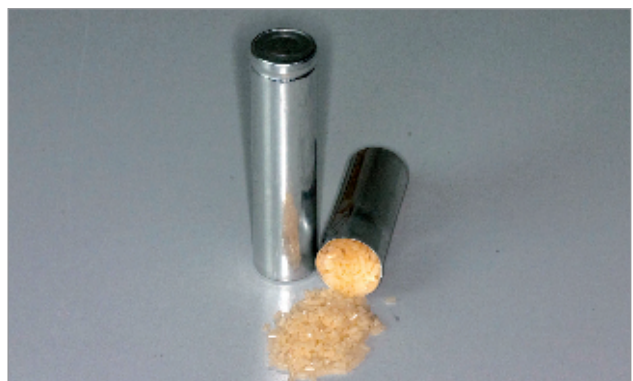
Abb. 5b: Kartusche mit Kunststoffgranulat.
